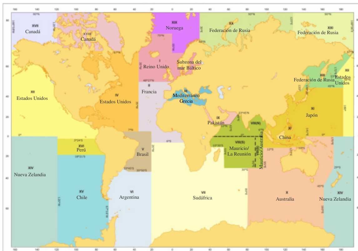
Figura 4: Zonas METAREA para la coordinación y difusión de radioavisos y pronósticos meteorológicos en el marco del SMSSM
