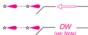
M5.1 Derrota de un sentido y derrota para buques de gran calado basada en un sistema de marcas fijas
